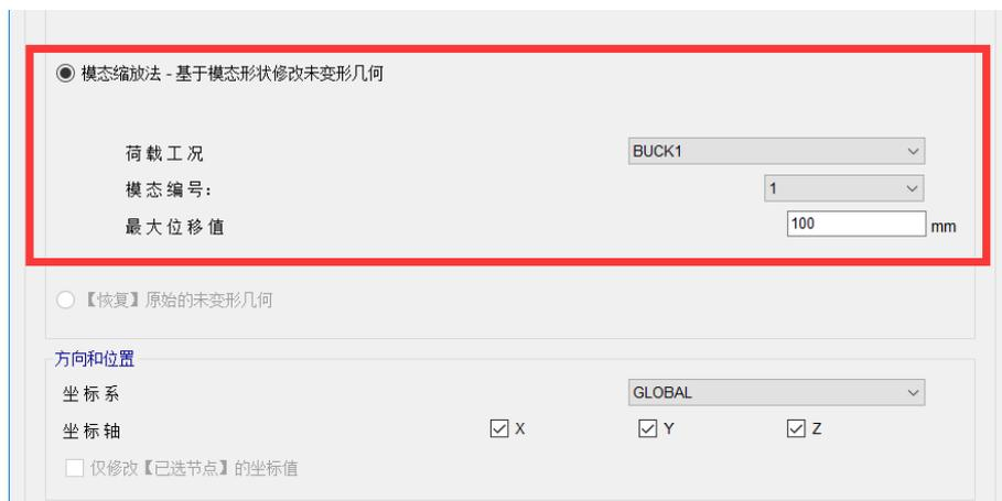
图 5 施加结构初始缺陷
