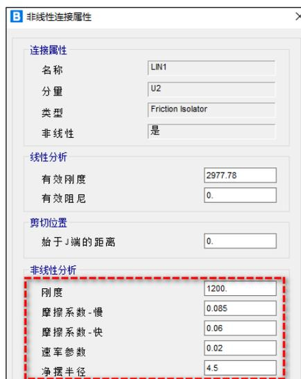
图 9-b U2 方向非线性连接属性
