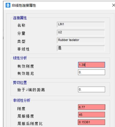
图 6-b U2 方向非线性连接属性
