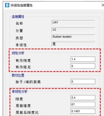
图 4-b U2 方向非线性连接属性
