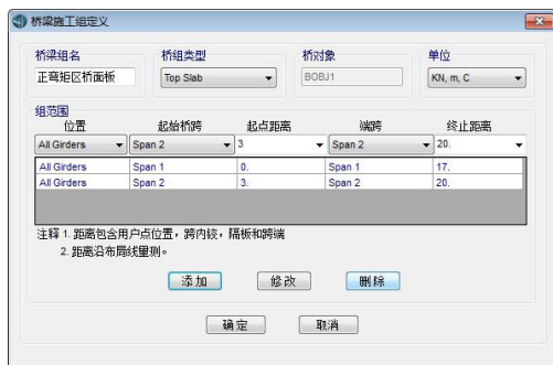
图 2-4 正弯矩区桥面板结构组设置
