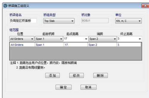
图 2-5 负弯矩区桥面板结构组设置
